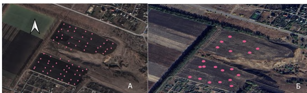
Рис. 2. Схема відбору проб ґрунту: А – на визначення вмісту органічного вуглецю, Б – на визначення гранулометричного складу
