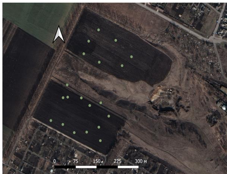
Рис. 2. Схема відбору проб ґрунту для визначення вмісту вологи на території дослідної ділянки
